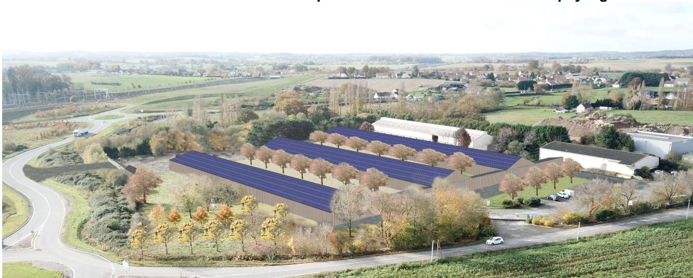
Le projet prévoit l'implantation en toiture de panneaux solaires de type photovoltaïques. La puissance qui sera mise en œuvre est estimée à environ 1800 kWc.
